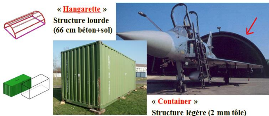
Fig. C6 : deux géométries-type traitées dans le projet RAIMANTA
